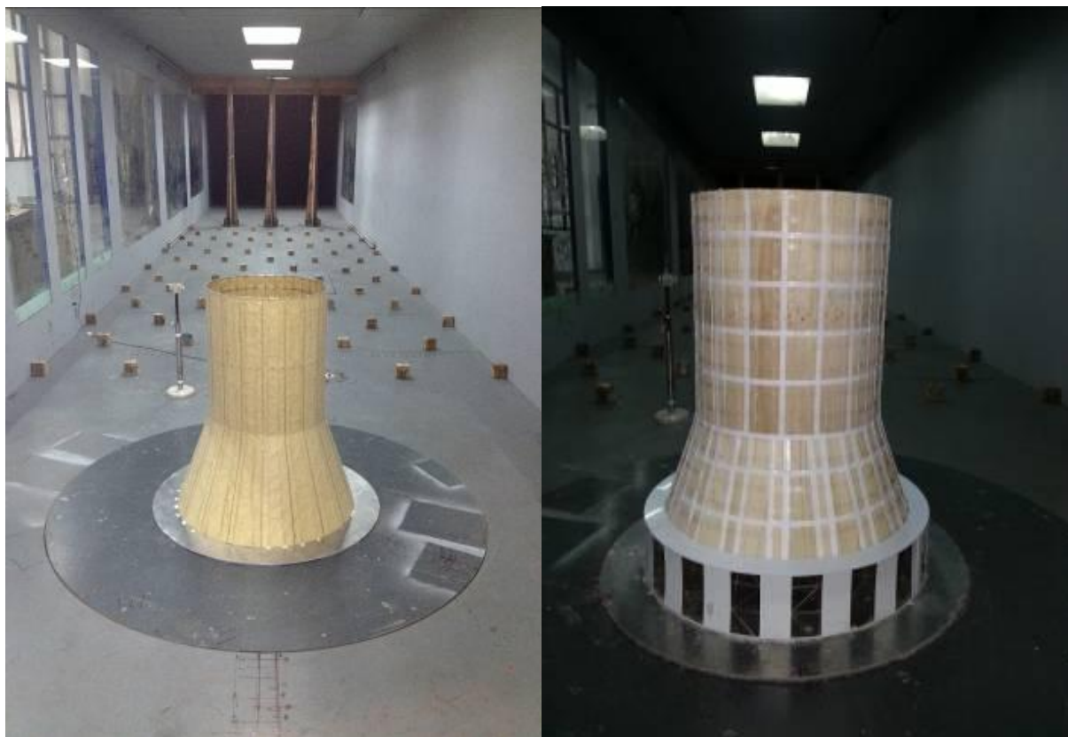
图6.2-2 气弹模型风洞试验
