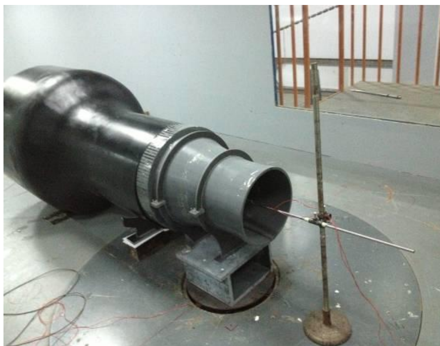
图6.2-3 内阻力试验模型
