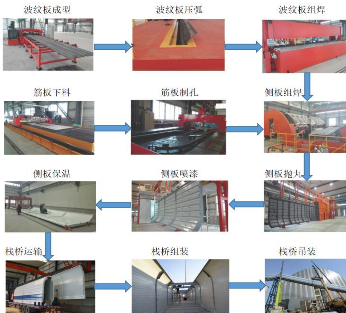
图2 成套式模块栈桥生产流程图
